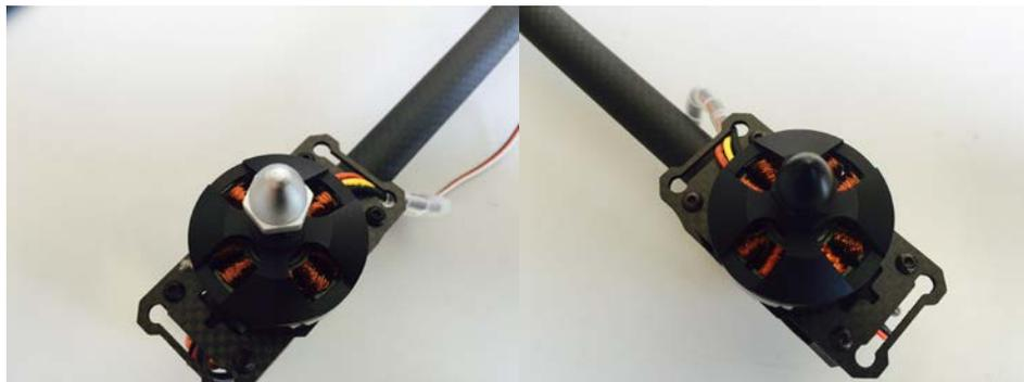
Achten Sie bei der Befestigung der Luftschrauben auf die Drehrichtung der Motoren und auf die Wirk-Richtung der Gewinde.
