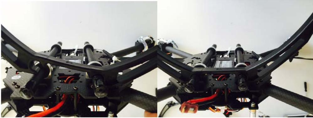
Drehen Sie das Modell auf den Rücken (legen Sie es nicht auf die Einheit oder die Antenne!!). Setzen Sie das Landegerüst auf einer Seite ein und klicken Sie es auf der anderen Seite fest.
