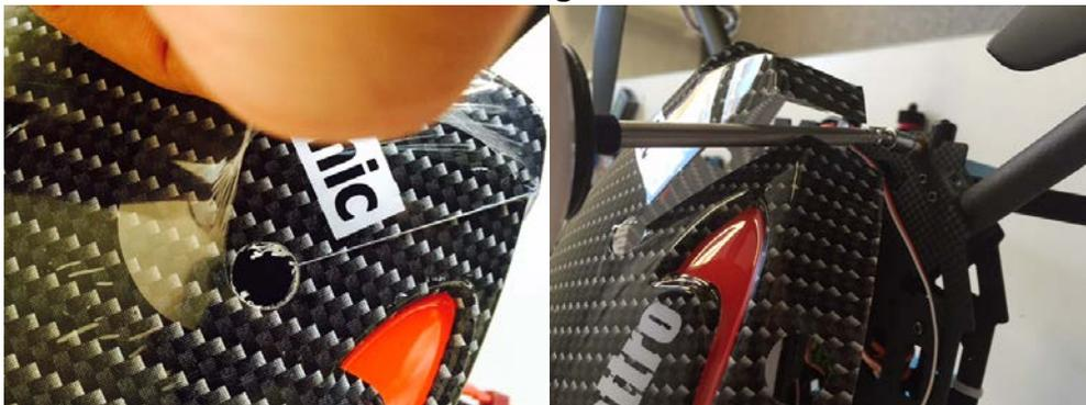
Ziehen Sie jetzt die Schutz Folie von der Haube ab. Führen Sie die Antenne wie folgt durch die Karosse und klicken Sie diese auf die Motorarme
